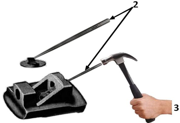
3. Frapper le punch pour dévisser l'écrou de la plaque
