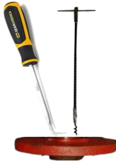
6. À l'aide de la perceuse à batterie et d'une brosse en tube (L tube brush) nettoyer le socle de la plaque de tête et l'orifice du presse étoupe pour les libérer de la corrosion et de la vieille étoupe.
